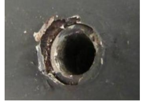
Laklaag rondom de schroefhuls is nog intact (linkse foto) danwel heeft onderhoud nodig (rechtse foto)
